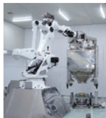
生薬の投入工程のロボットアーム
