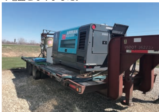
エンジンコンプレッサ サンドブラストのエア源
